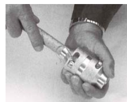
3. Stabi Rohr: Alumantel mit Schälwerkzeug entfernen.
